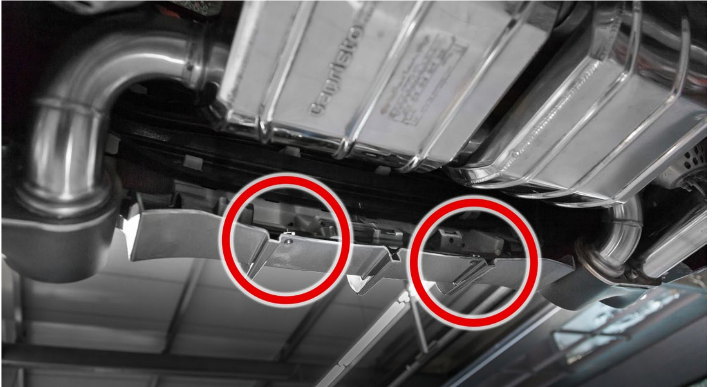
Schraubenpositionen am 435i (am 428i ähnlich) / screw positions on 435i (similar on 428i)
