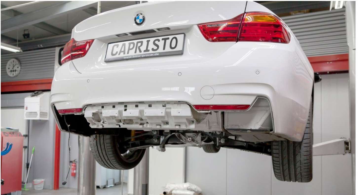
Original Schürze entfernen / remove OEM apron
