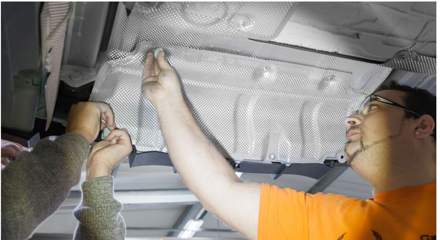
Nur 428i: Montieren Sie das Blech wieder / 428i only: re-assemble the sheet
