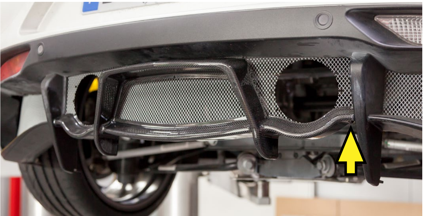
Neues Mittelstück ist aufgesetzt und verschraubt (s. Pfeil). New middle portion is attached and screwed together (see arrow).
