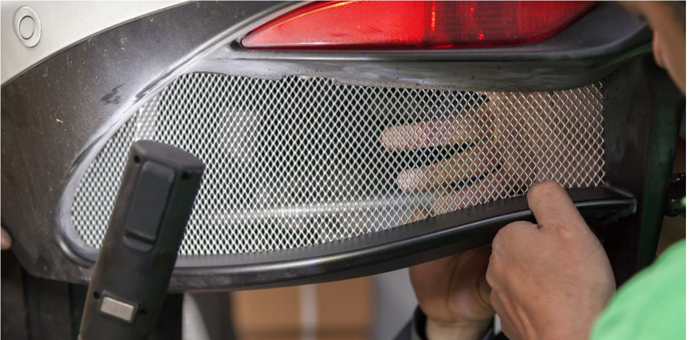
Neue Gitter einsetzen/Insert new meshes
