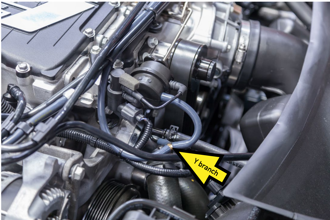
Unterdruck mit Y-Stück abgezweigt/vacuum branched by Y-piece
