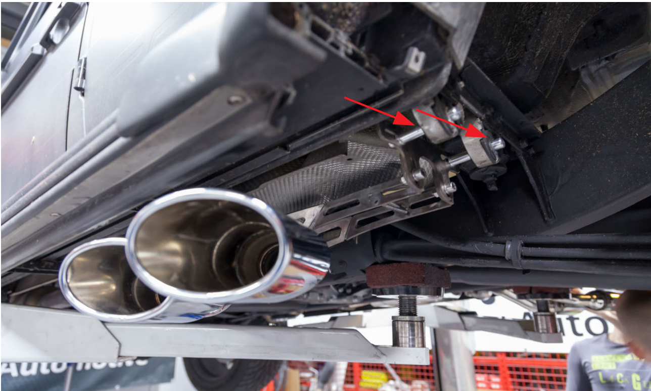
Abb.6: Capristo- Schalldämpfer in den Haltegummis pic. 6: Capristo- muffler in the rubber holdings
