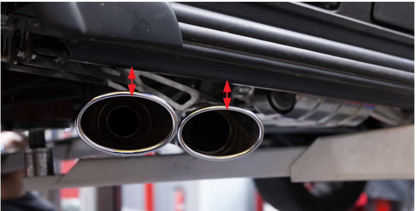
Abb.7: Endrohrposition Capristo- Schalldämpfer pic. 7: end- pipes position of Capristo- muffler
