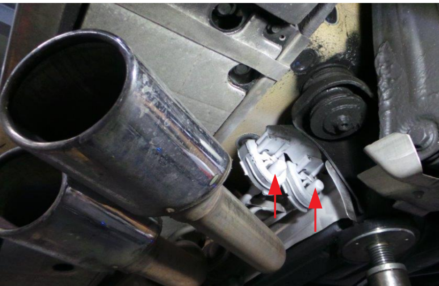
Abb.5: Aushängen des Endschalldämpfers pic. 5: removing the muffler from the holdings
