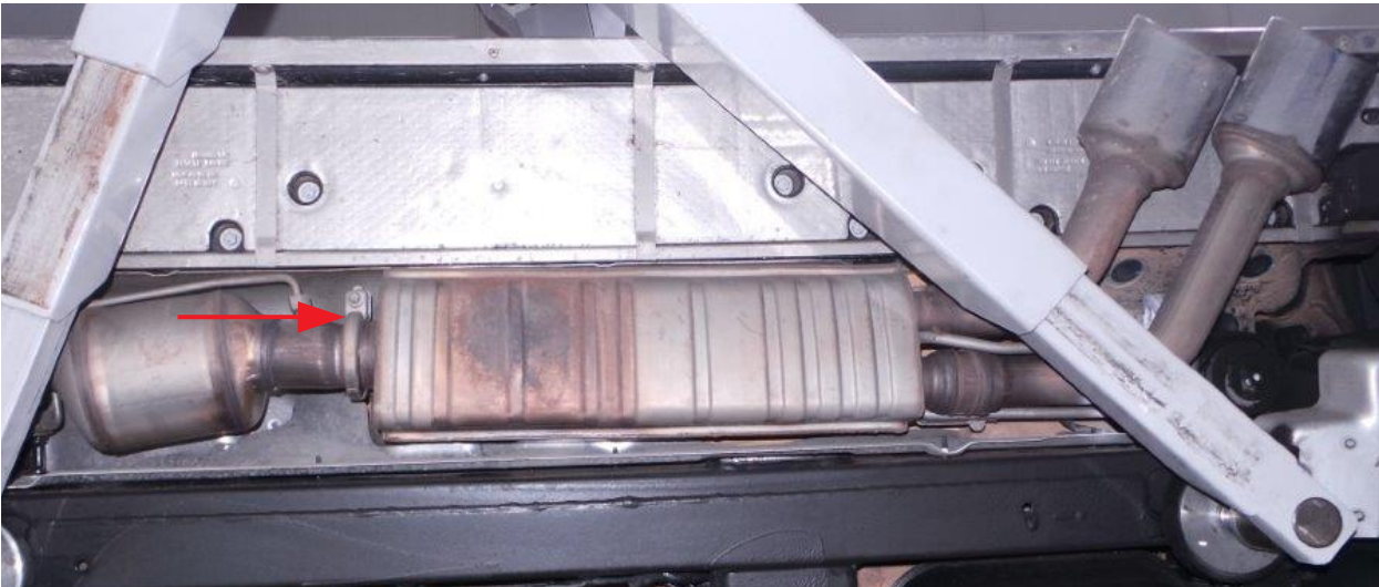
Abb. 4: Verbindung Endschalldämpfer zu Kat/OPF Pic. 4: connection muffler to kat/OPF
