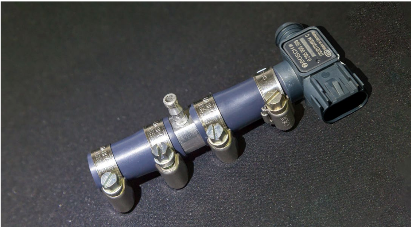
Splitter vorbereiten / prepare the splitter
