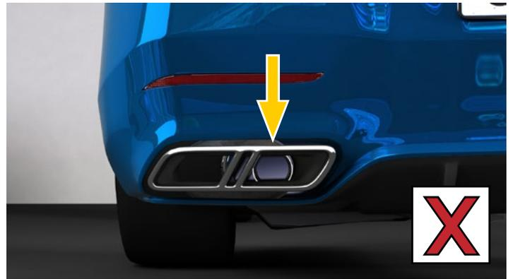
Ausgang der Abgasanlage zum Eingang der Blende zentrieren.
