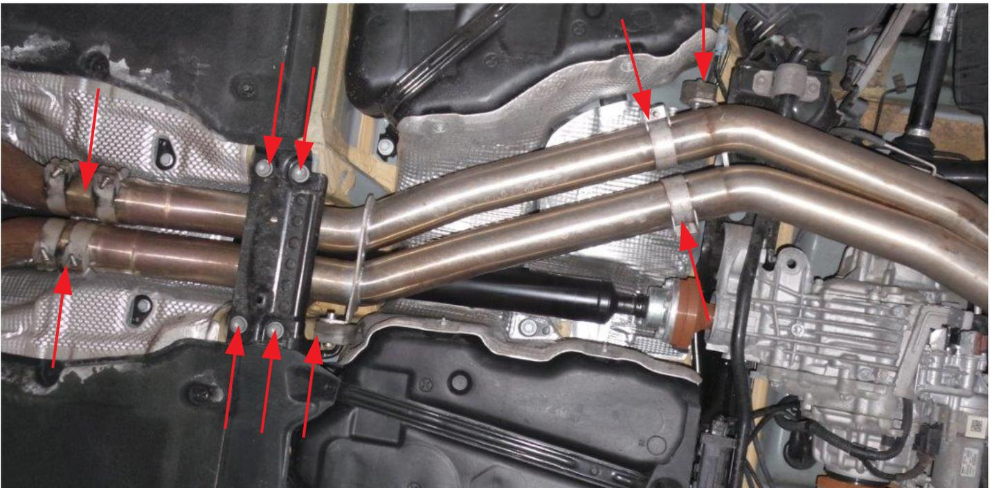
Abb.8-10: Capristo- Schalldämpfer in den Haltegummis
