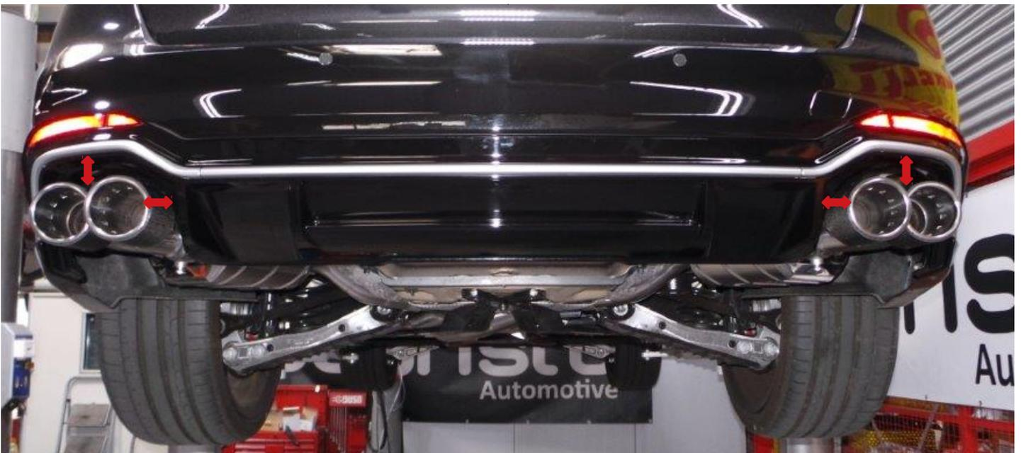
Abb.11-13: Endrohrposition Capristo- Schalldämpfer
