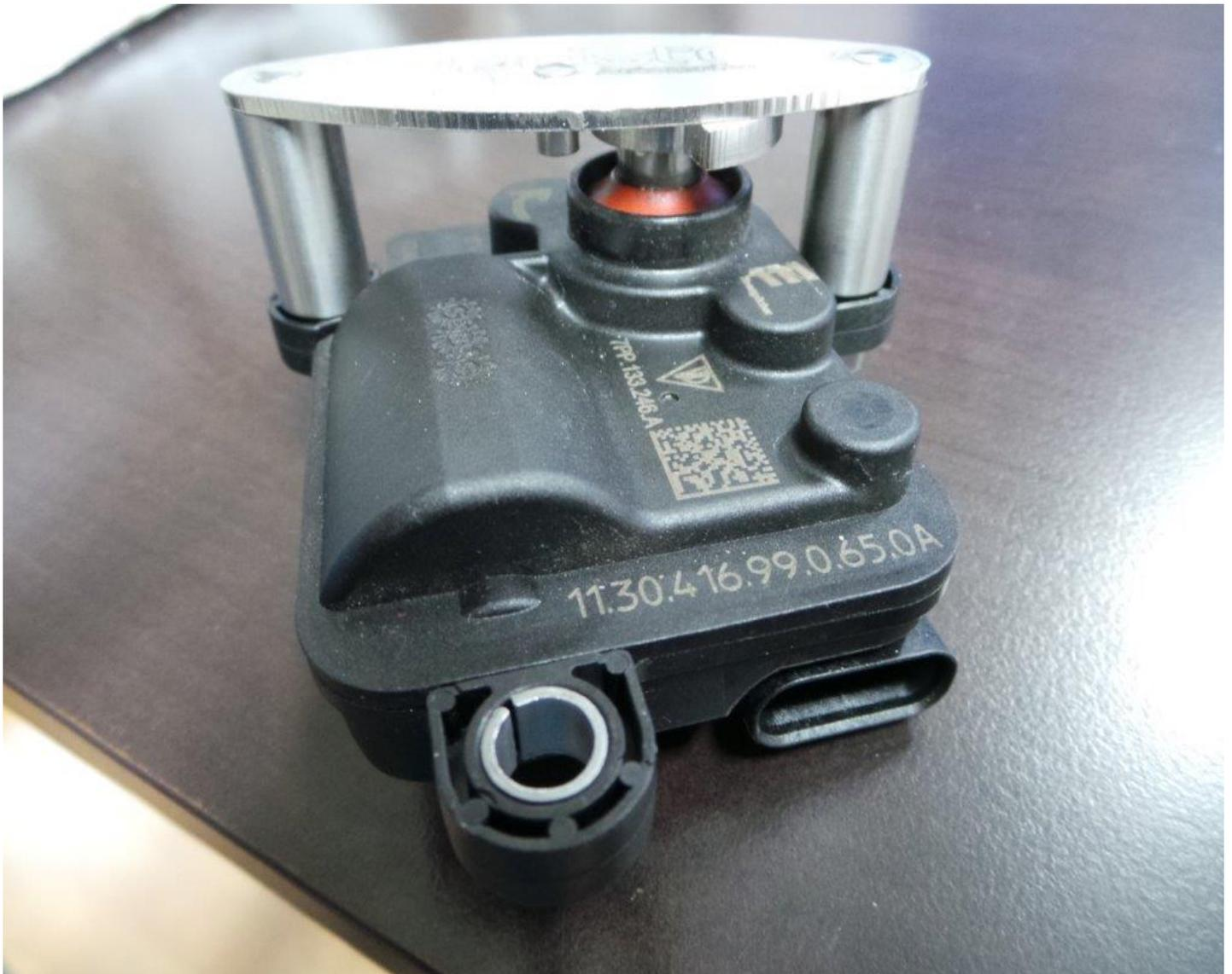
Abb.39-44 Anschlagplatte E-Motor
