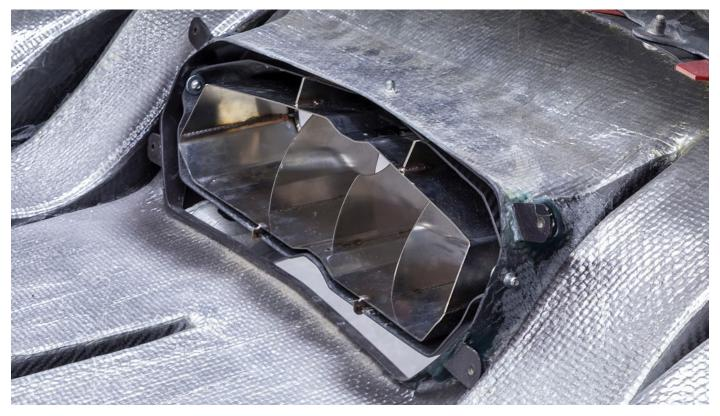
Die Endrohrblende wird mit 3 Schrauben (links, oben, rechts) befestigt. Positionieren Sie die Blende und zeichnen Sie die zu bohrenden Löcher an. Die Neigung kann mit Langlöchern abgestimmt werden.
