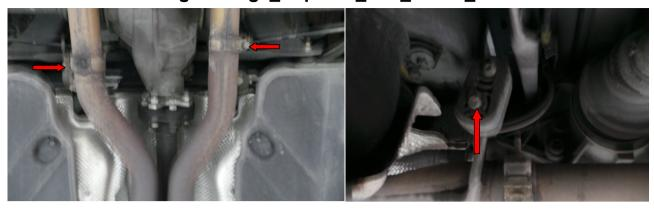
Die Serienverbindungsschellen der Endschalldämpfer maximal lösen und von den Formstücken herunter schieben, auch hier wird eine Schelle wieder verwendet und die zweite entfällt. Jetzt die Abgasanlage aus den Haltegummis heraus drücken und vom Fahrzeug entnehmen.
