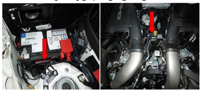
Das Steuergerät für die Abgasklappen wird im Motorraum neben der Batterie positioniert und angeschlossen, der Unterdruckeingang für das Magnetventil wird aus dem Motorraum an einer originalen Stelle abgegriffen.
