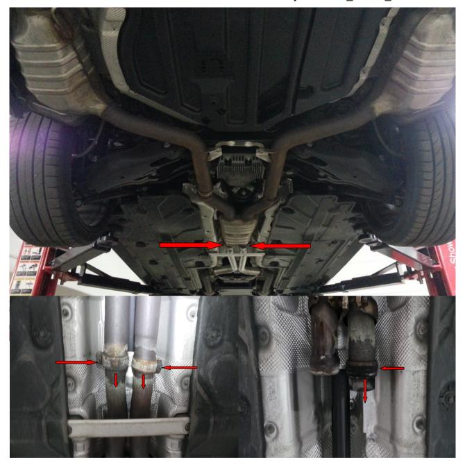
Die gelösten Serien Verbindungsschellen von den Formstück herunter schieben. Eine der Serien Verbindungsschellen wird wieder verwendet, die zweite und der Schiebedichtungsring entfallen.
