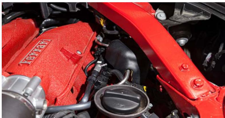
DE | Schließen Sie nun den Vacuum Schlauch von Capristo an dem Adapter an.
