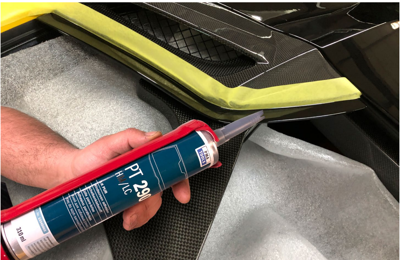
Klebeflächen mit Scheibenkleber versehen. Put glue onto the surfaces.
