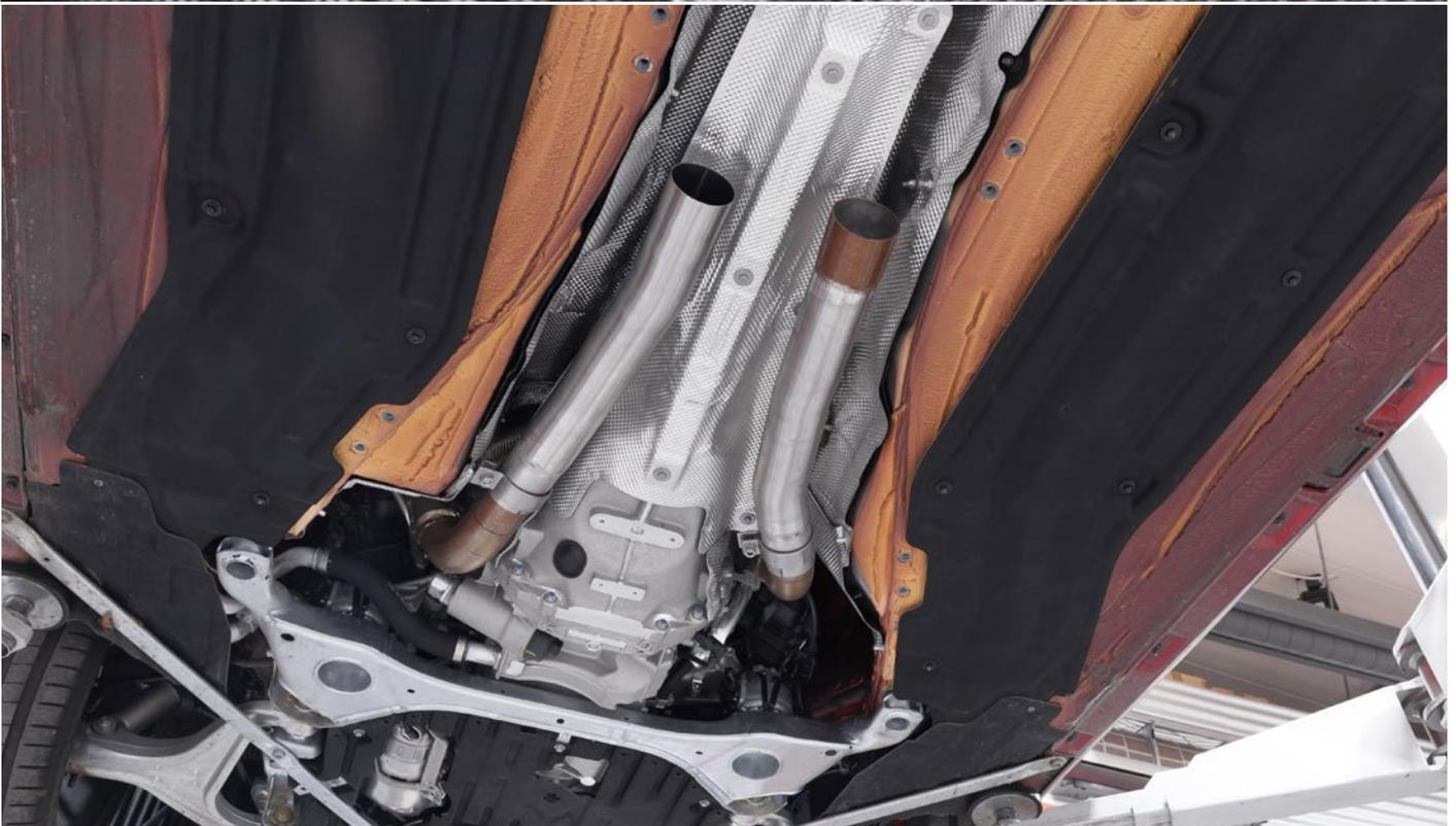
Katersatzrohr aufgesteckt/cat spare pipe put on
