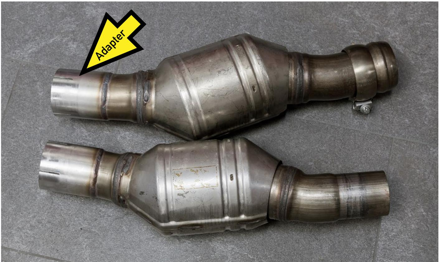
Originalkatalysator mit Adapter vorbereitet für den Rückbau/original cat prepared with adapter for retreat working
