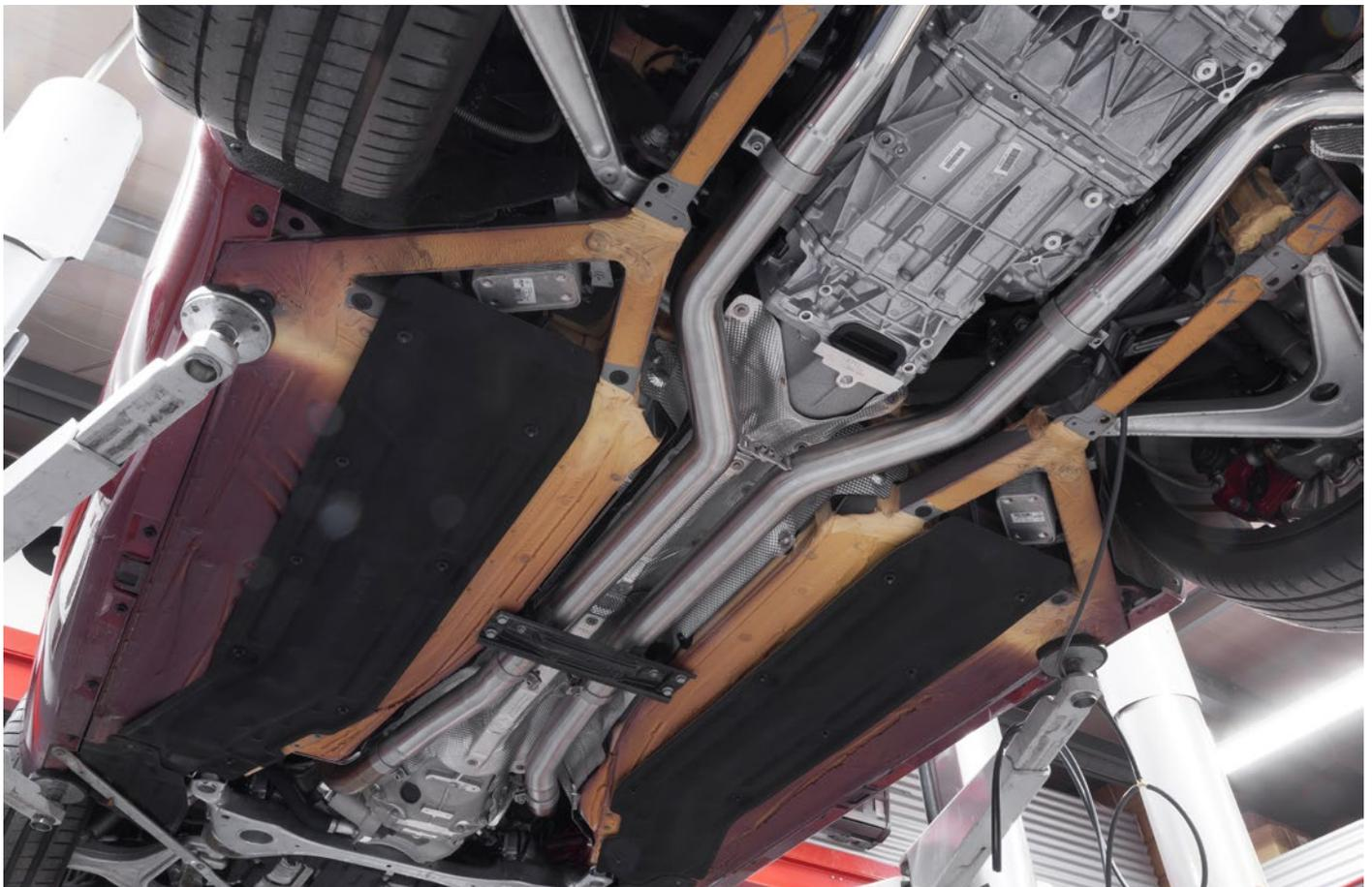
Mittlere Rohre sind eingebaut/middle pipes are installed
