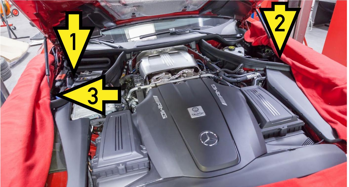
1. Position des Steuergeräts/position of the controller, 2. Antenne (langes Kabel)/antenna (long cable),
