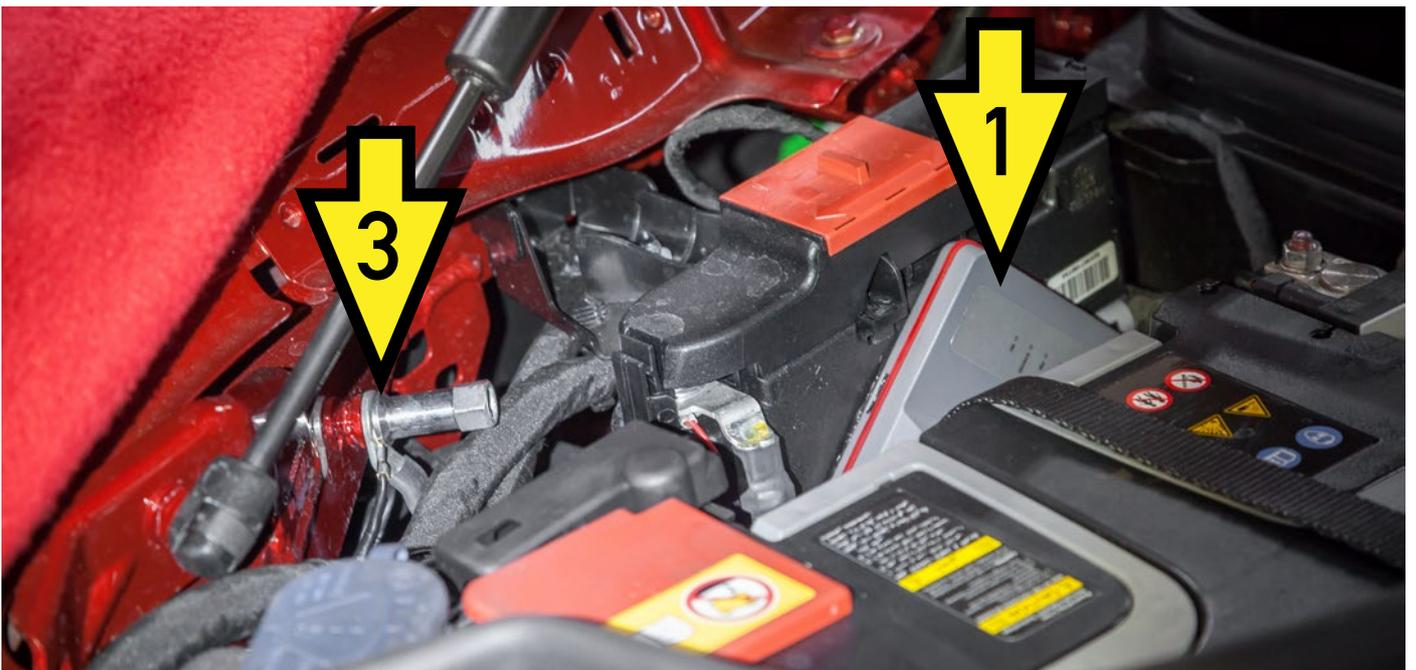
1. Position des Steuergeräts/position of the controller
