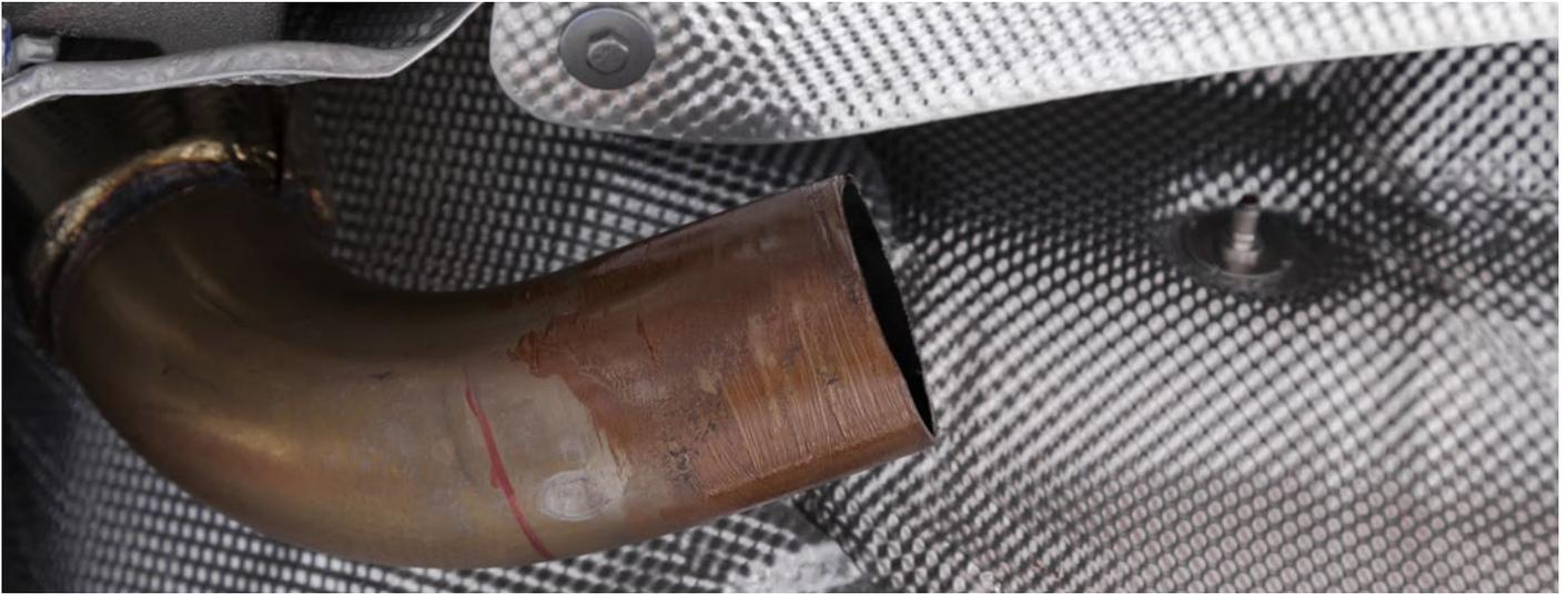
Katalysator abgetrennt/cat cut off
