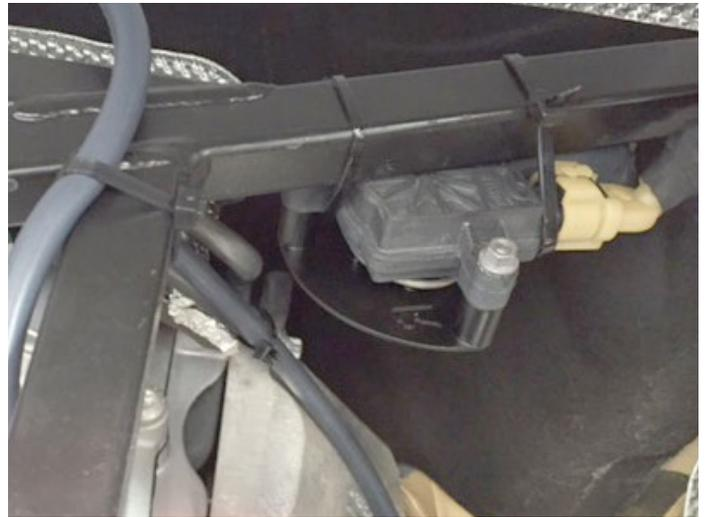
Die Stellmotore der Originalanlage werden demontiert, mit den mitgelieferten Anschlagplatten (L/R) verschraubt und an einer freien Stelle am Kfz befestigt, sodaß sie nicht stören. Die Kabel bleiben angeschlossen und die sensorischen Abläufe des Kfz bleiben so erhalten.
