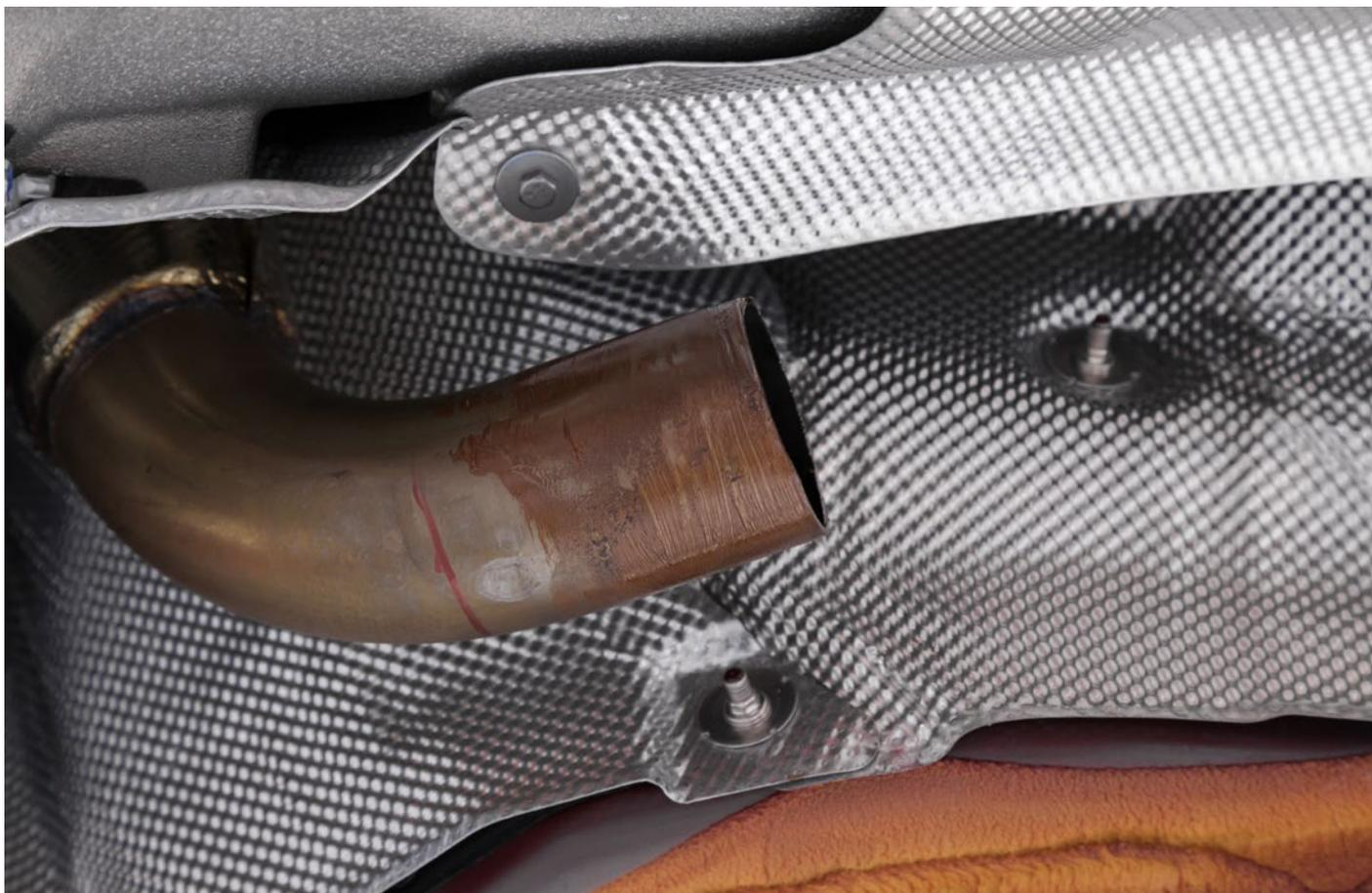
Katalysator abgetrennt/cat cut off
