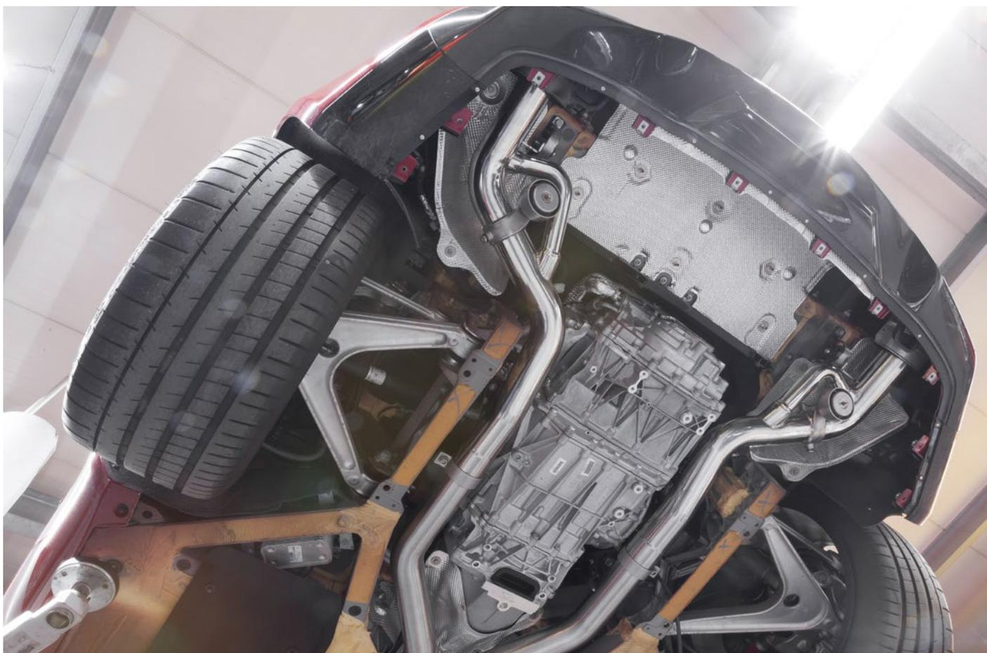
Hintere Rohre sind installiert/rear pipes are installed
