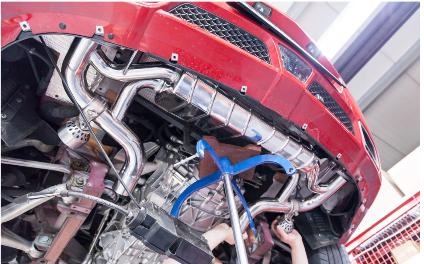
Endschalldämpfer und Rohre montieren
