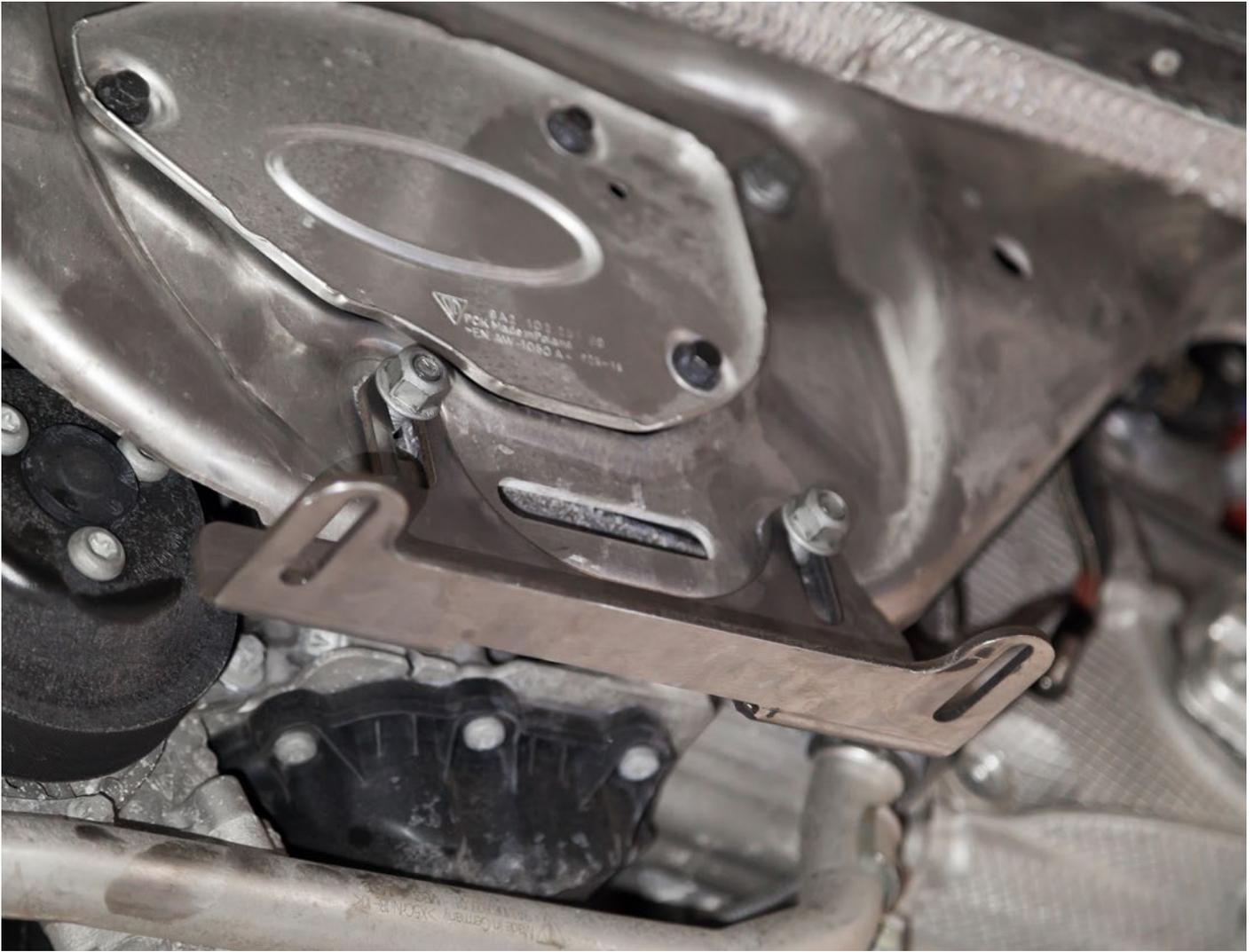
**Befestigen Sie den CAPRISTO-Halter und die Abgasanlage.
