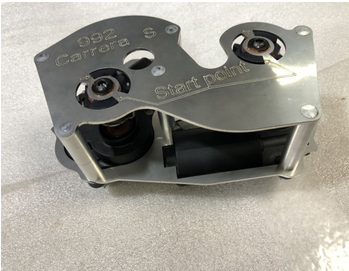
Abb. 15-18: Montage der OEM Actuatoren auf die Capristo Anschlagplatte Pic. 15-18: Mounting the OEM actuators on the Capristo stop plate
