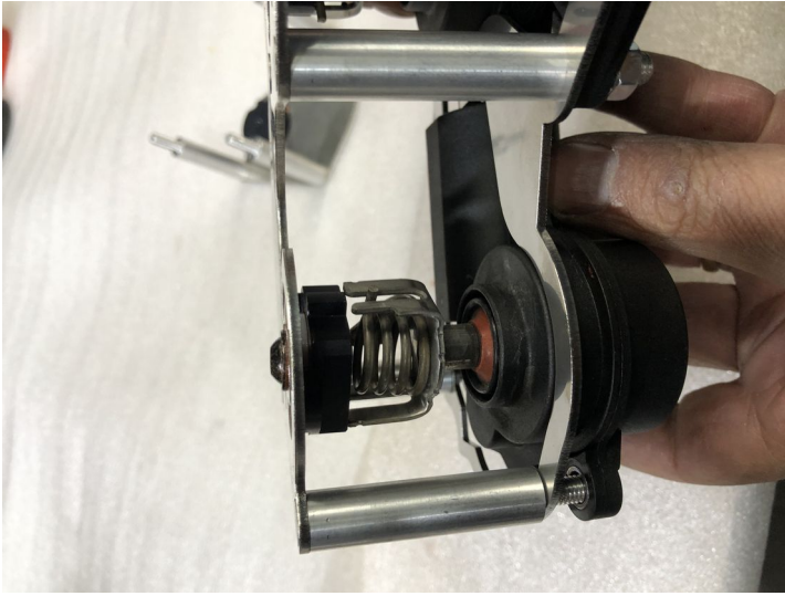
Abb. 15-18: Montage der OEM Actuatoren auf die Capristo Anschlagplatte Pic. 15-18: Mounting the OEM actuators on the Capristo stop plate
