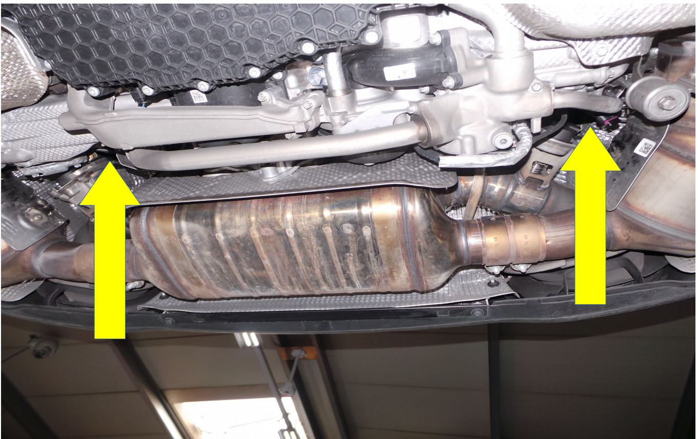
Abb. 1: Stecker der OEM Aktuatoren entfernen Pic. 1: remove the OEM electric actuator plug
