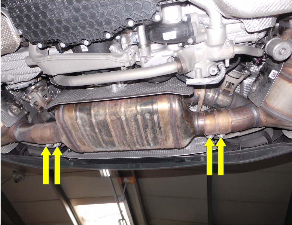
Abb. 4: Lösen der Verbindungsschellen Endschalldämpfer zu Katalysatoren Pic. 4: Releasing the connection clamps Rear silencer to catalytic converters
